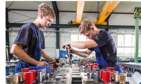
Die Werkzeuge werden in unserem Hause entwickelt, konstruiert und gefertigt. Während das Arbeitsgebiet des Zerspanungsmechanikers die Fertigung von Einzelteilen an modernen CNC-Maschinen umfasst, ist beim Werkzeugmechaniker Handarbeit gefragt. Er montiert aus unzähligen Einzelteilen das fertige Werkzeug. Euch erwartet ein vielfältiges Arbeitsgebiet mit täglich neuen Herausforderungen in einem jungen Team.
